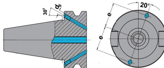
**Werkstoff:** Legierter Einsatzstahl mit einer Zugfestigkeit im Kern von min. 1200 N/mm<sup>2</sup>. Einsatzgehärtet HRC 60 ± 2 (HV 700 ± 50), Härtetiefe 0,8 mm ± 0,2 mm, brüniert und präzisionsgeschliffen.
