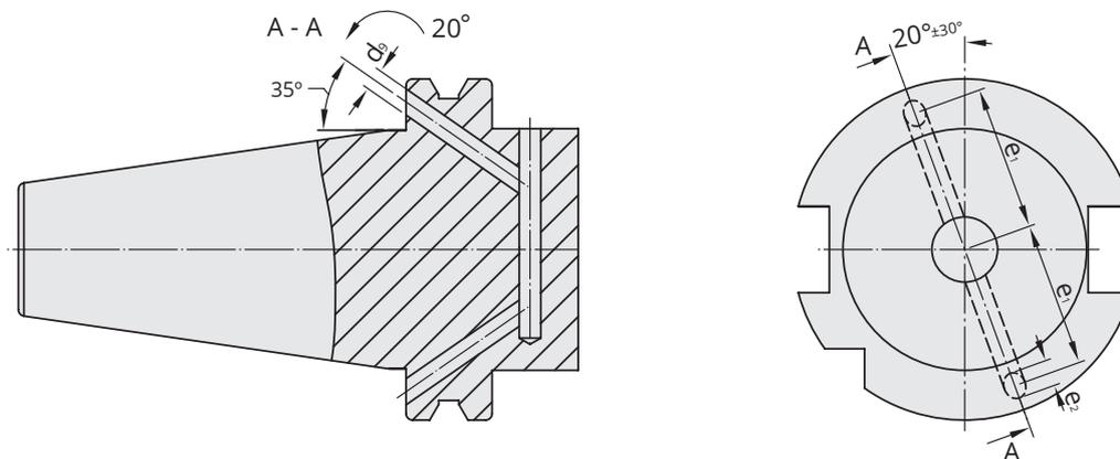
**Werkstoff:** Legierter Einsatzstahl mit einer Zugfestigkeit im Kern von min. 950 N / mm<sup>2</sup>. Einsatzgehärtet HRC 60 ± 2 (HV 700 ± 50), Härtetiefe 0,8 mm ± 0,2 mm, brüniert und präzisionsgeschliffen.
